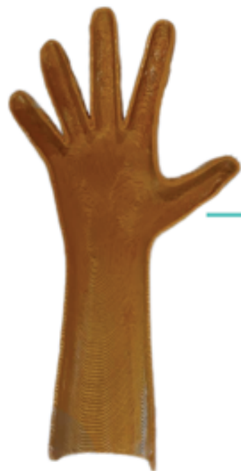
اسپلینت آنتی اسپاستیک دست، ساخته شده بوسیله اسکن و پرینتر سه بعدی
